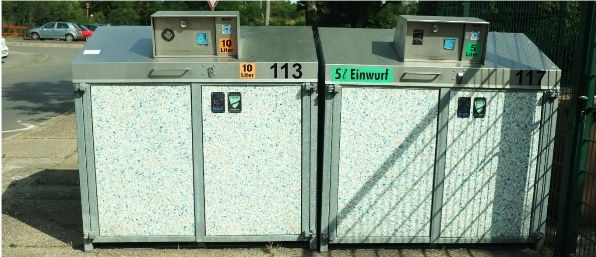
Abbildung 34: Müllschleusen für die Restmüllfassung im Stadtgebiet Stendal (Foto: Böhm)
